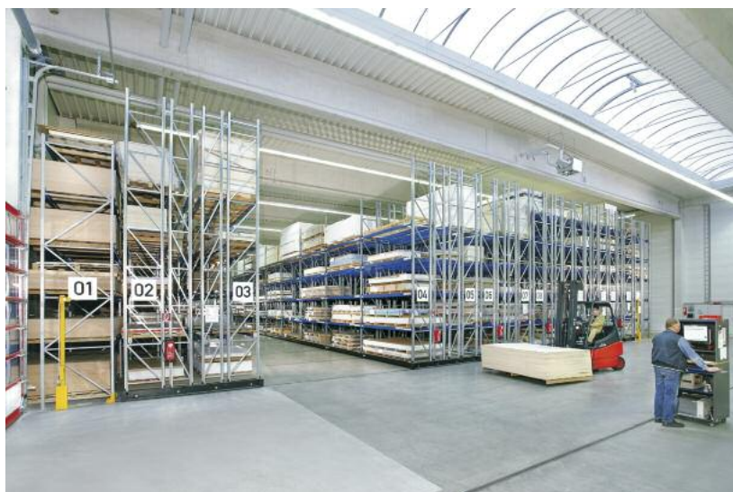
Das Verschieberegallager von Weiss Chemie in Haiger wird von PSIwms verwaltet. Die Software wurde innerhalb von drei Monaten installiert
