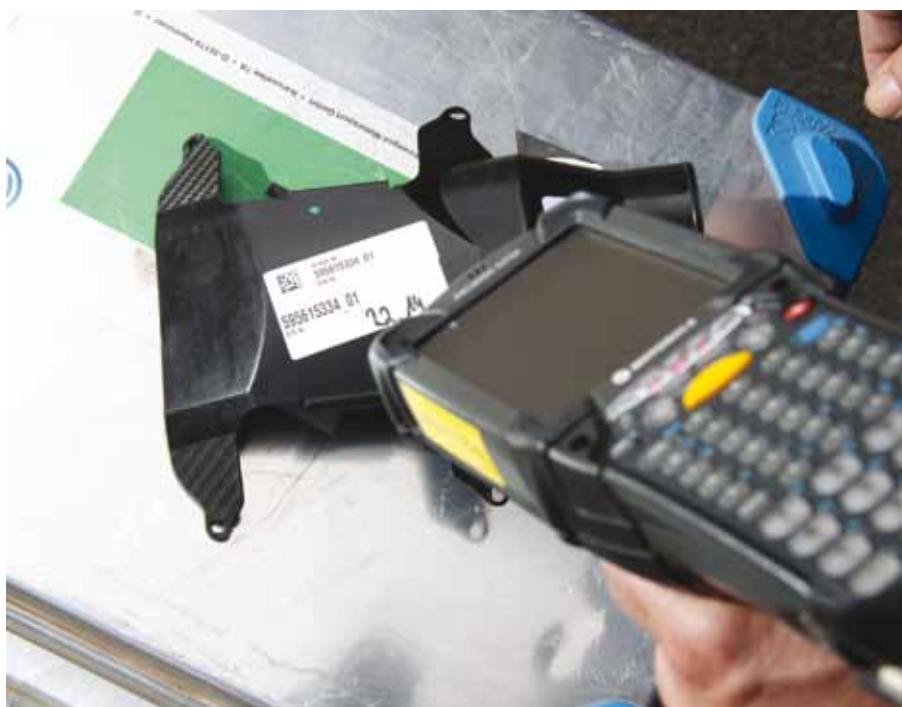
С помощью сканеров штрих-кодов учитывается каждая замена деталей.
