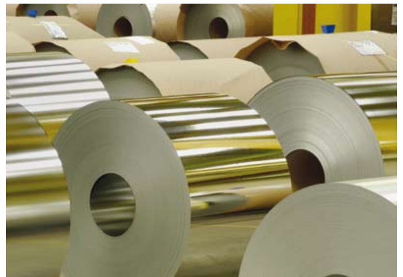
Coils - Oberflächen von matt bis hochglänzend. Die Oberfläche des Weißblechs wird dem Kundenwunsch entsprechend durch das Nachwalzen und die Art der Zinnaufgabe beeinflusst.
