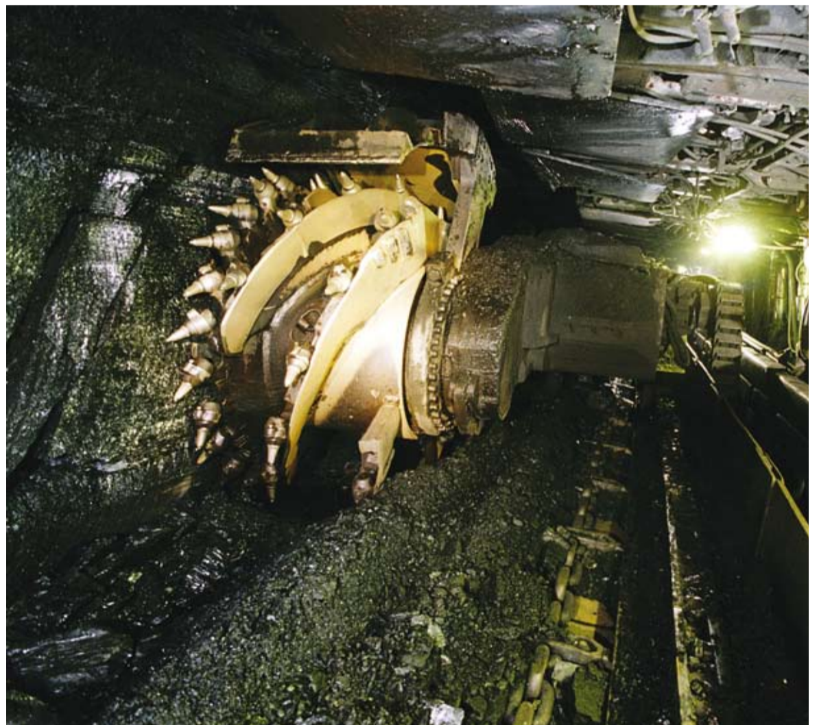
Abb. 1: Schneidwalze eines Walzenschrämladers
