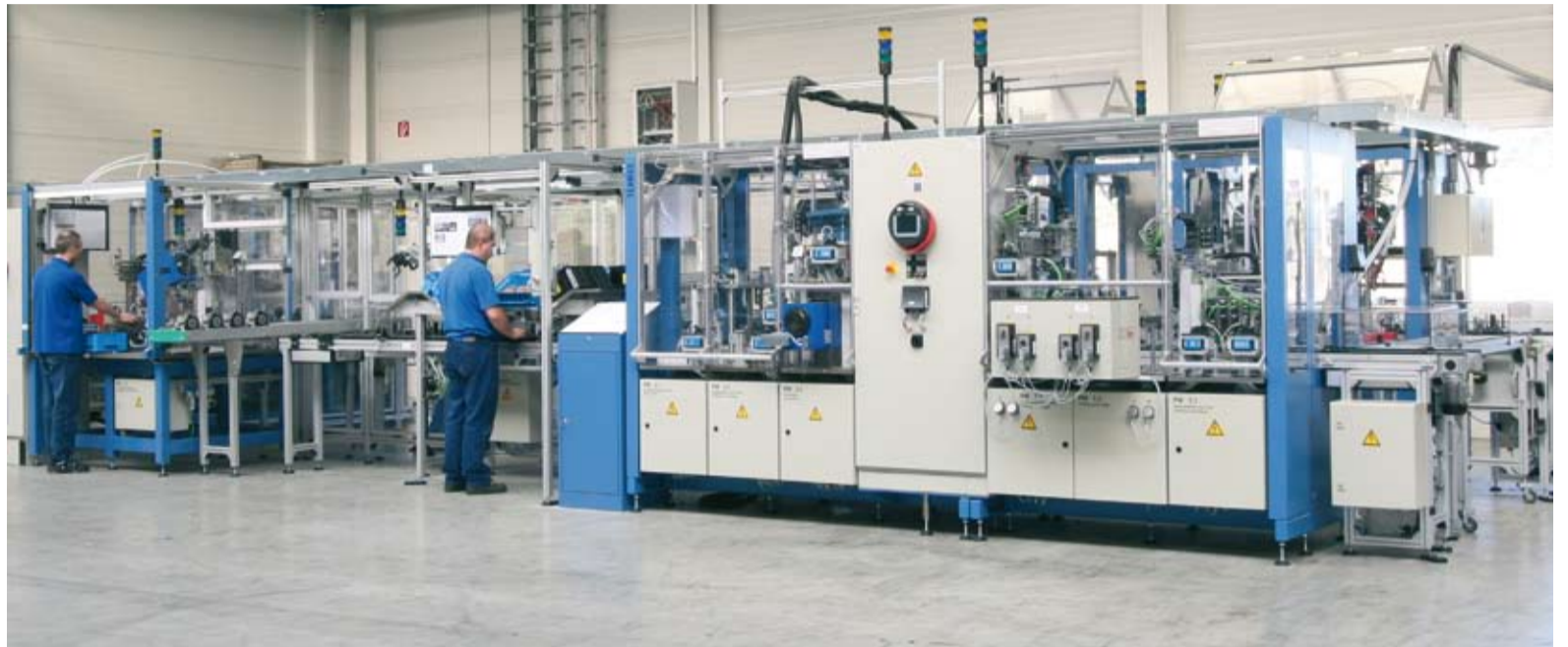
Montagesystem TEAMOS - produktneutrale Plattform für Montage- und Prüftechnik für jede Anlagenkonfiguration nach Kundenwunsch.
