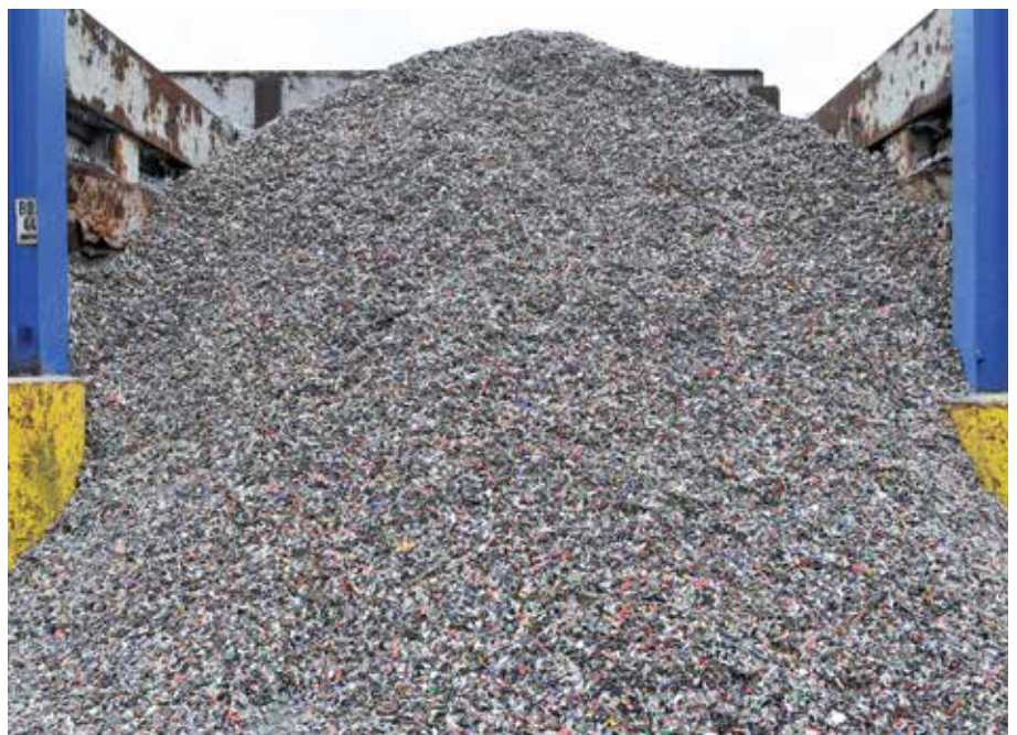
Ausgangsmaterial beim Aluminium-Recycling: Produktionsabfälle und Schrotte.
