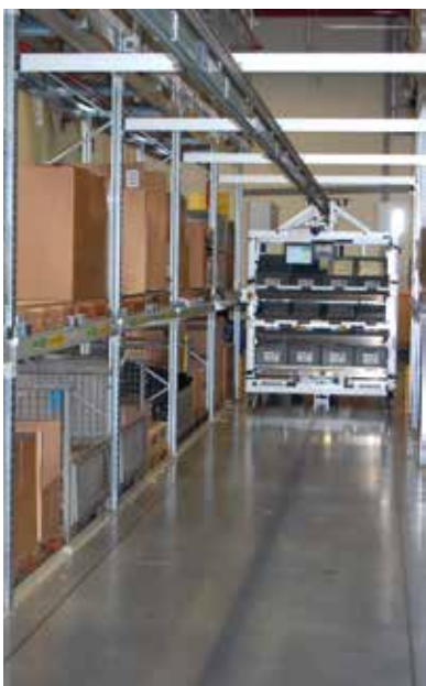
PSiWms leitet Pickmobile wegeoptimiert durch die Kommissioniergänge.
