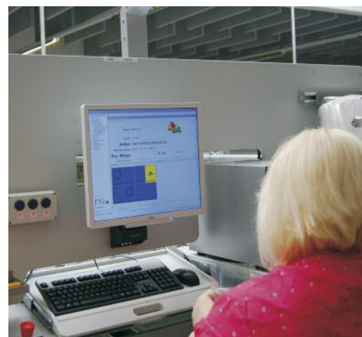
Das WMS unterstützt die Kommissionierprozesse durch optische Bildschirmvorgaben
