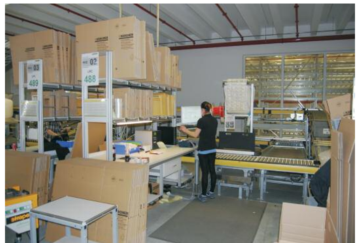
Für die optimale Versandverpackung wählt das WMS anhand hinterlegter Stammdaten die passenden Kartonagen aus
